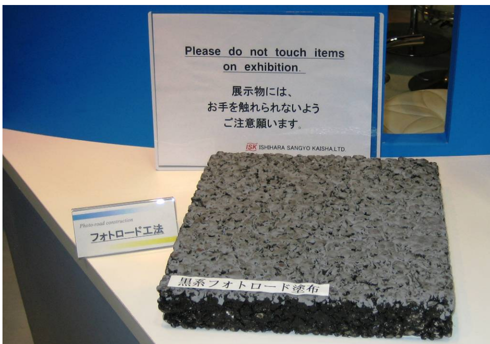
Figur 23. Coating på asfalt sk. photo-road.
